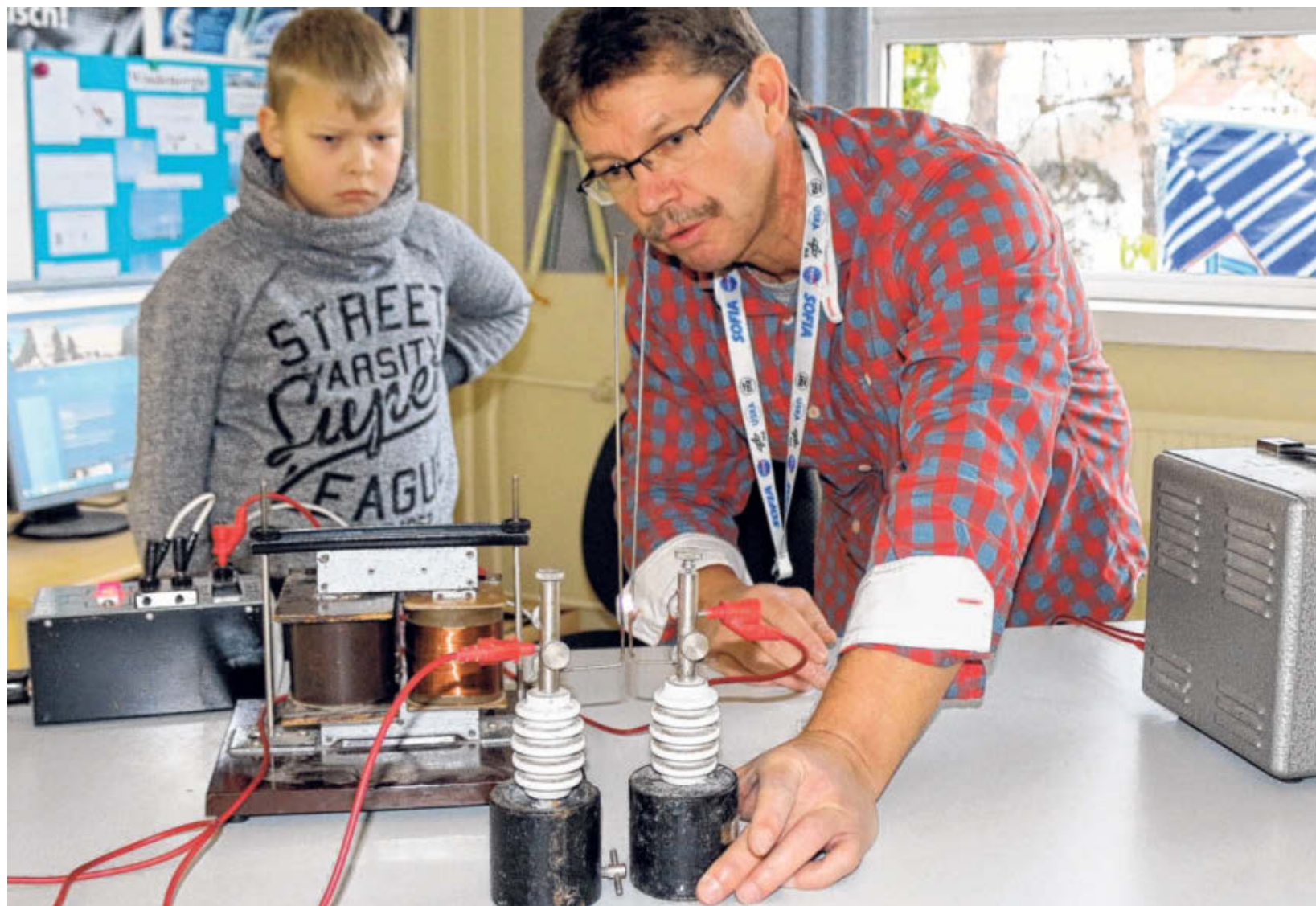
Physiklehrer Volker John demonstriert Tom Grönke, wie er einen Lichtbogen zwischen den beiden Drähten wandern lässt.
